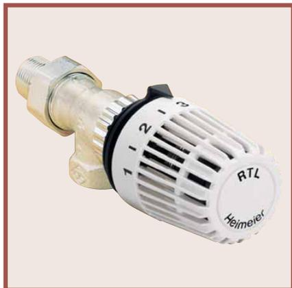
Omezovač teploty zpětné teplotnosné látky (RTL) firmy HEIMEIER je samočinně pracující proporcionální regulátor teploty. Teplota protékající teplotnosné látky se přenáší na čidlo. Nastavená teplota je udržována v rozmezí proporcionálního pásma konstantní. Ventil otevírá teprve po poklesu teploty protékajícího teplotnosného media pod nastavenou hodnotu.
