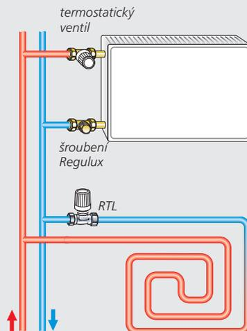
U temperovaných podlah je třeba předem zkontrolovat a případně upravit teplotu přívodní vody tak, aby vyhovovala hygienickým a bezpečnostním předpisům pro podlahové vytápění.
